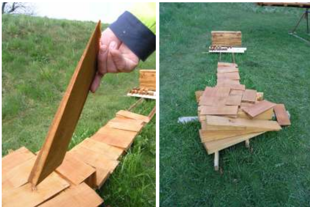
Träkilar till fastsättning och finjustering av vingarna i axeln.
