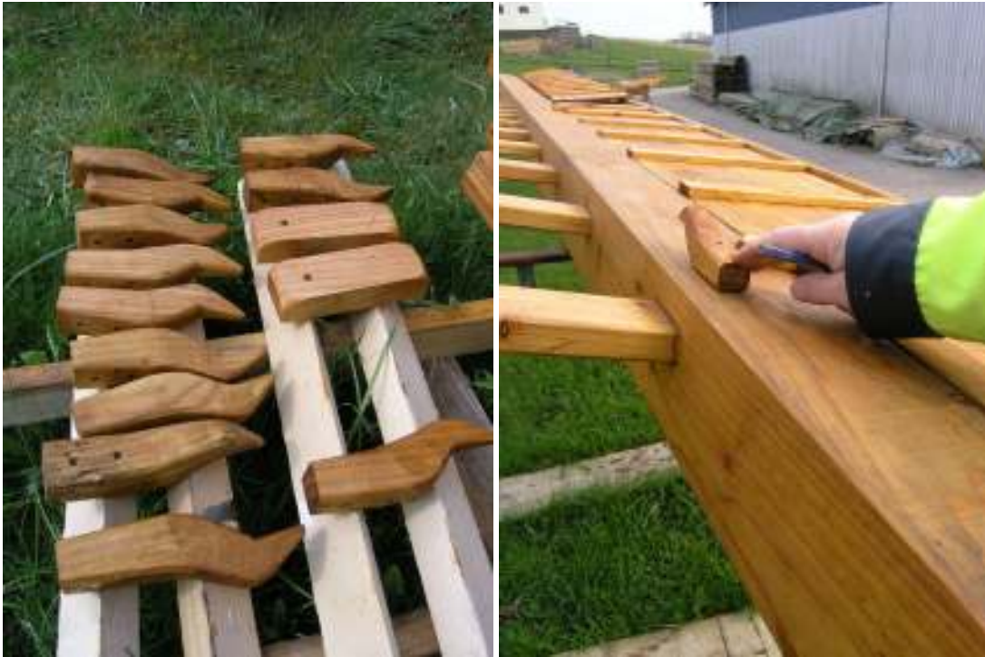
Segelkrokar i väntan på montering på vingarna.
