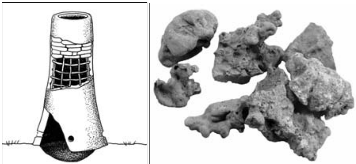
Fig. 12 a-b. Till vänster ses en rekonstruktion av en blästugn av det slag som det har påträffats ett antal av i Bromöllatrakten. Skiss efter originalakvarell av Kerstin Åberg i Englund 2002. Till höger ses en del av slaggen från en av ugnarna som undersökts i södra delen av Bromölla, nära den gamla E22:an. Foto Tony Björk.
